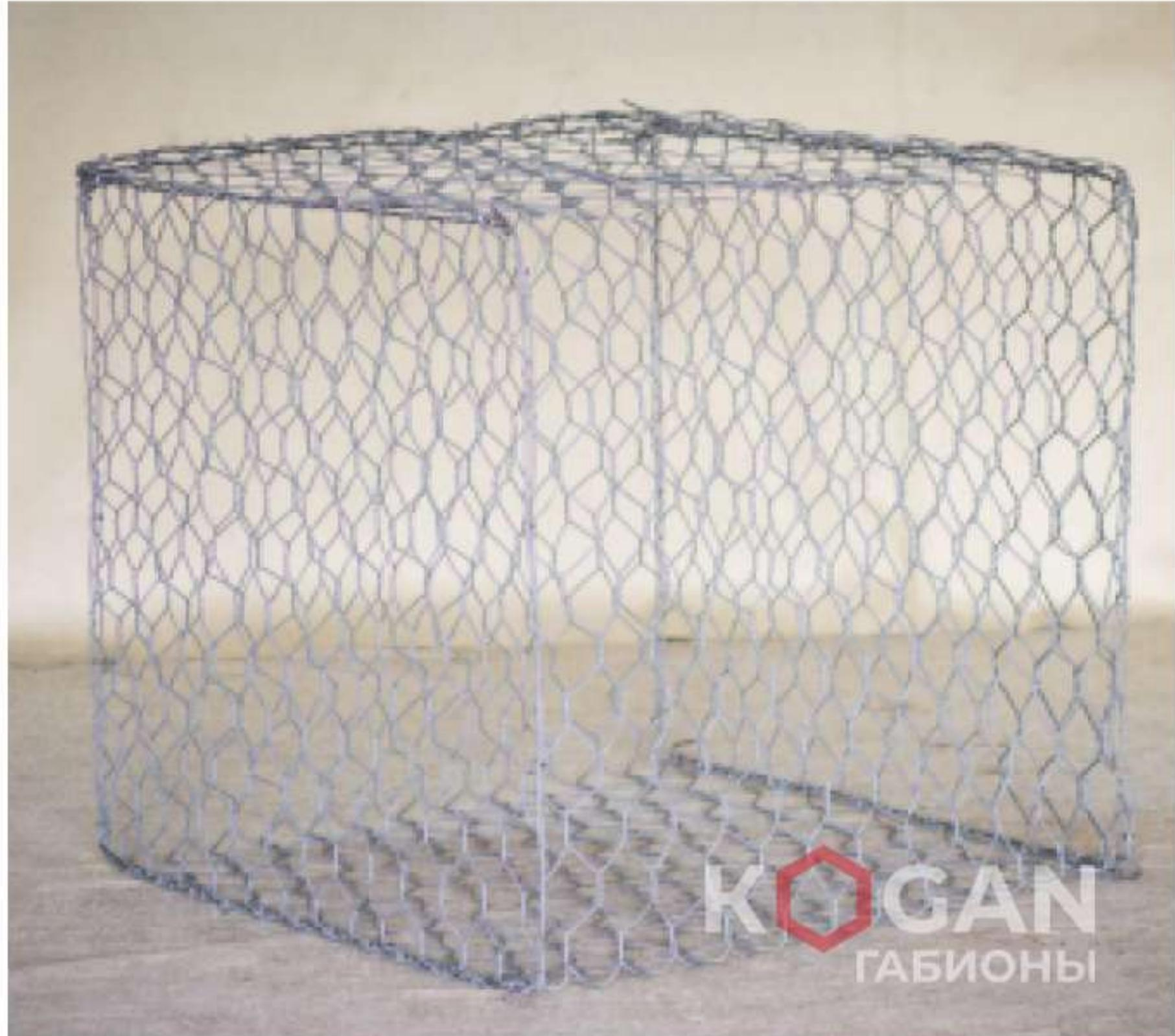
По форме это ящики из сетки. Обычно изготавливаются длиной от 1 до 4 метров, шириной в пределах 1-2 метров и высотой 0,5-1 метр. Внутри конструкции есть диафрагмы с шагом 1 метр, они повышают ее жесткость и прочность.
