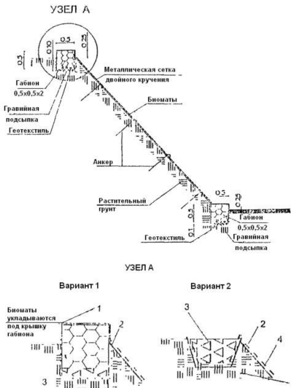
Рис. 3.3. Схема крепления откосов с использованием биоматов и коробчатых габрионов:
