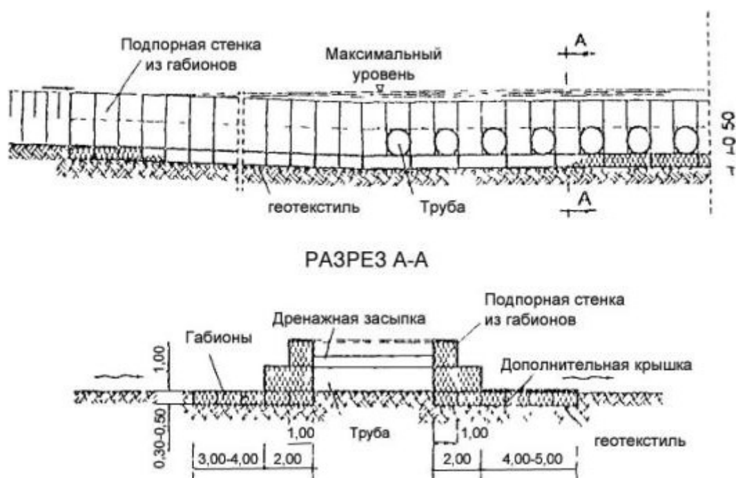
Рис. 7.3. Схема устройства габрионного переливного сооружения с круглыми водопропускными трубами.
