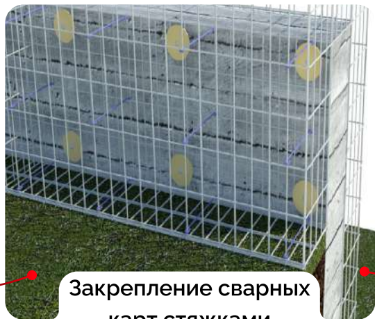
Установка сварных карт и закрепление их анкерными креплениями
