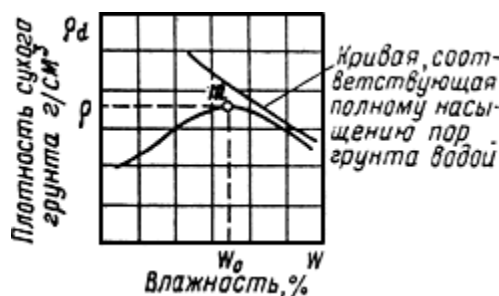
Рис. 15. Зависимость плотности сухого грунта от влажности
